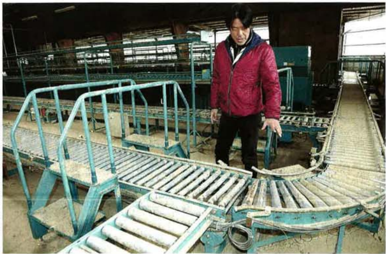
コンベヤーに泥が残るなかの農協みゆき果実共選所。浸水で機器類が故障し、復旧にはコンベヤーを交換する必要がある。6日午後0時1分、中野市上今井
