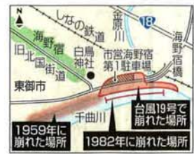
千曲川右岸は台風19号で、たつて崩落した。崩落幅も40メートルあり、堤防とその内側にあった市道白鳥神社線、市営海野宿第1駐車場が流れ、海野宿橋は堤防の内側にあった橋台が横転。橋が落ちる危険性があり、下を通るしなの鉄道は田中一田間が約1カ月間運休となった。
