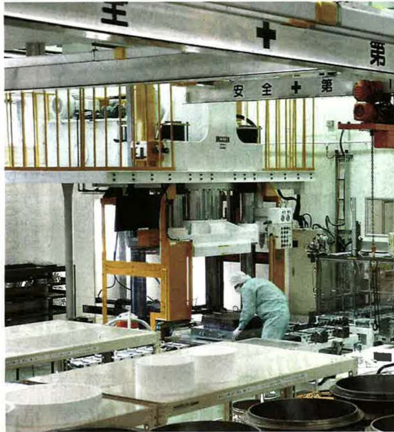
操業を再開したニッキフロンの新工場。油圧ポンプ(上の黄色い柵内)は高い位置にあり、浸水を免れた
